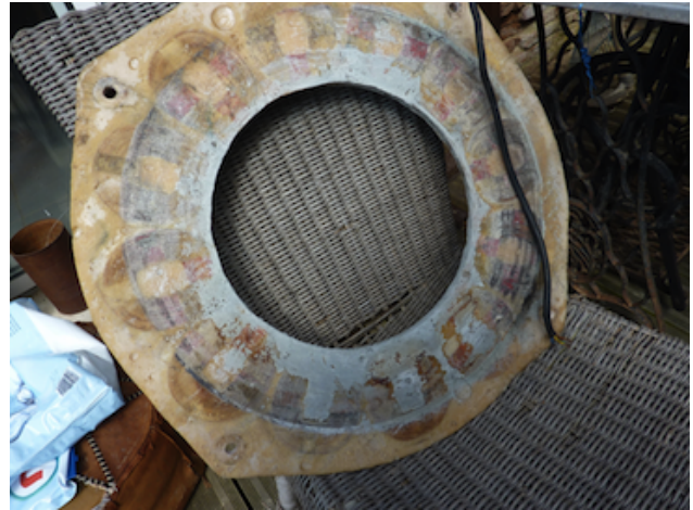
Exemple de stator sur lequel un des rotors a frotté
